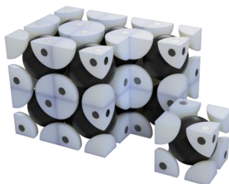
Figura 6 – Representação macroscópica da estrutura CCC
