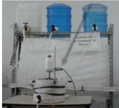
Figura 2 – Aula prática do reator CSTR: perturbação do tipo. Construída pelos discentes PET para graduação
