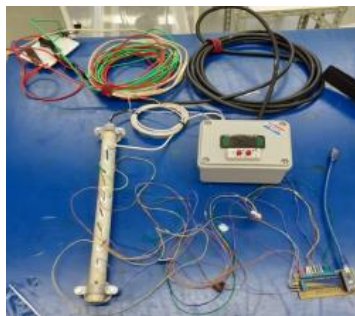
Figura 3 – Aula prática de transferência de calor: unidade experimental contendo barra metálica e o arduíno.
